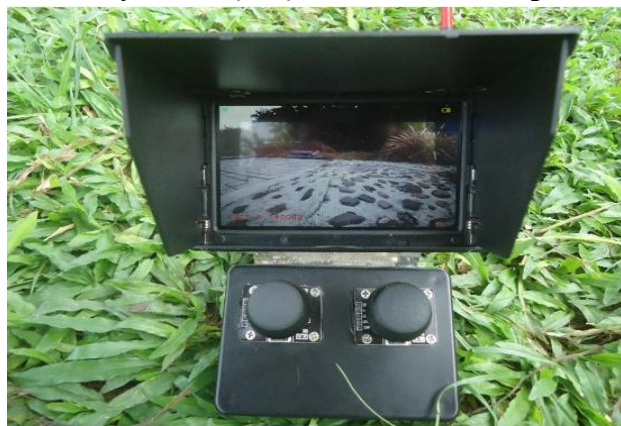
Hình 4. Bàn điều khiển trung tâm (Thiết bị điều khiển, giám sát – Trung tâm chỉ huy)
