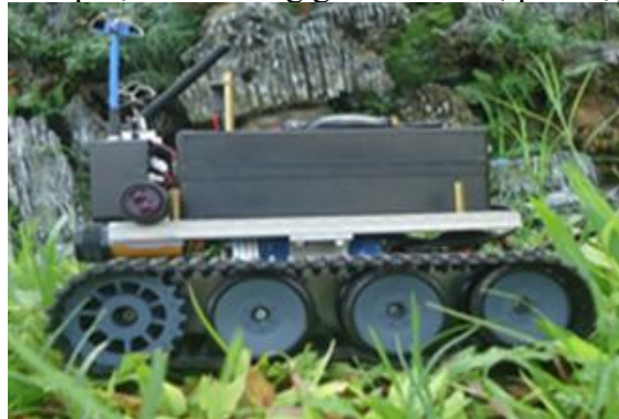
Hình 2. Mô hình của thiết bị robot SQ26 sau khi lắp ráp, thử nghiệm trên thực tế - Đánh giá so sánh với robot trinh sát đa nhiệm với robot tự hành RBH-18
